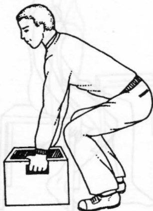
a) Správné zvedání Špičky nohou jsou těsně u břemene, ruce lze k břemenu přiblížit pokrčením kolien.
