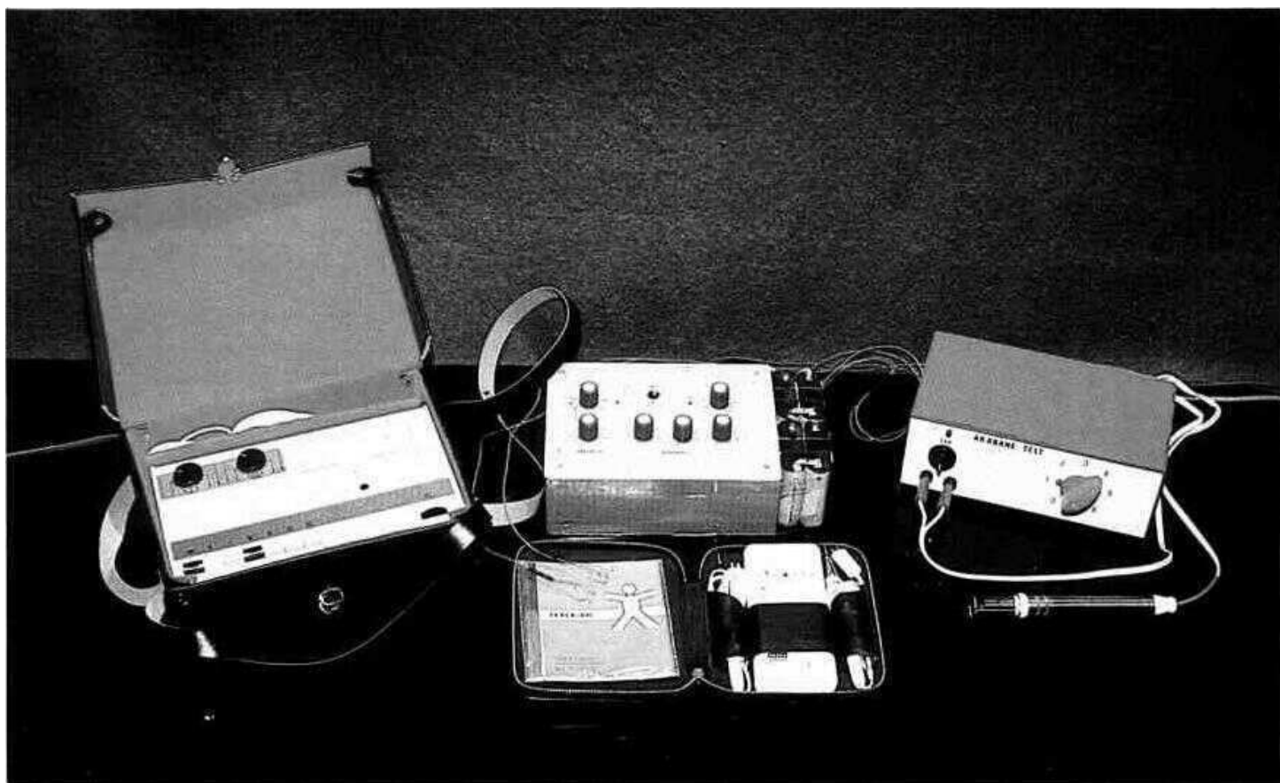
Obr. XI. Niektoré prístroje používané na vykonávanie modifikácií akupunktúry Zľava doprava: prístroje na elektropunktúru Akudias I. (výrobca Metra Blansko) a Stimul 3 (výrobca Tešia Liberec) prístroje na elektroakupunktúru hypalgéziu a elektromoxibusciu vlastnej výroby
