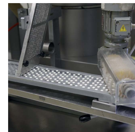
vtlačování tablet do blistrů
