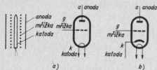
Obr. 4-4. Řez elektrodovou soustavou a schematické značky triody: a - přímo žhavené, b - nepřímo žhavené
