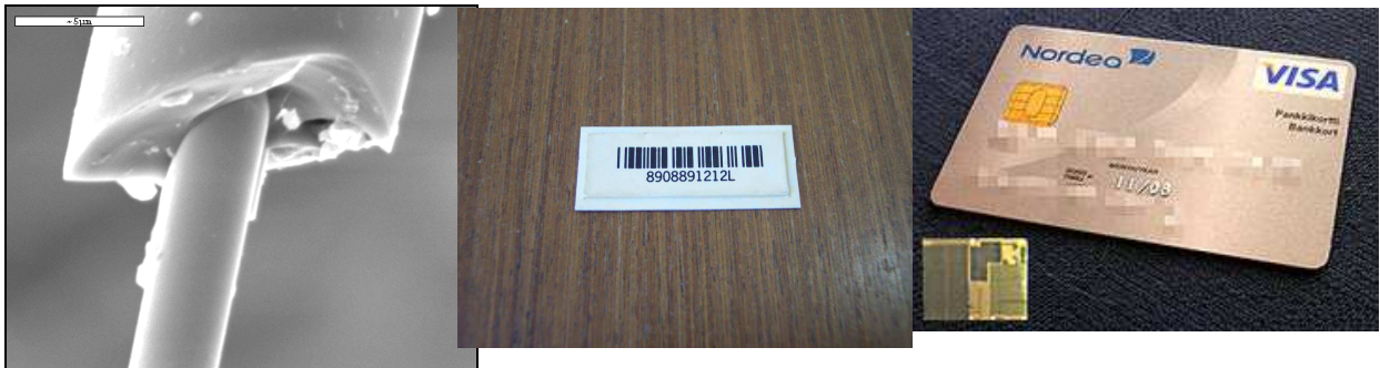
Obr. 5. Vľavo je magnetický mikrodrôt FeSiB pre senzory, v strede je bežný čiarový kód na obale výrobku, vpravo je klasická kreditná karta.
