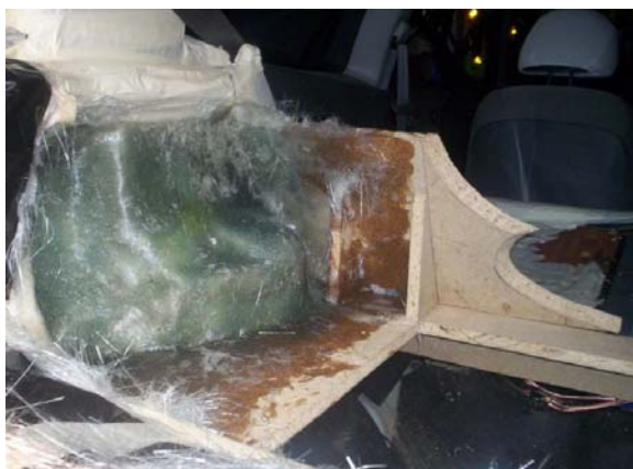
Obr. 1 Ukážka laminovania atypickej časti automobilu
