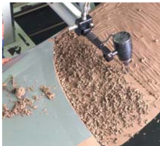
Obr. 6 Výroba prototypov z hlíny pomocou počítačom riadenej frézy
